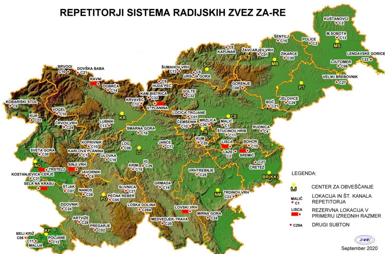
Slika 4: Repetitorske postaje s kanali sistema ZA-RE
